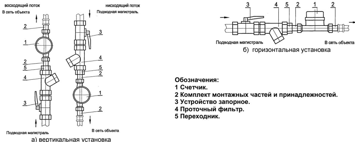
Рисунок 1 – Варианты установки счетчика
